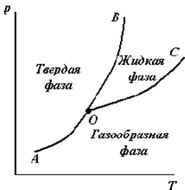
Рис. 5.1. Диаграмма состояния однокомпонентной системы
