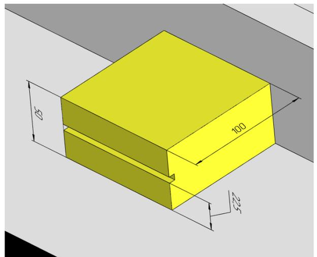
Рисунок 16 – Геометрические размеры принимающего сигнала блока
